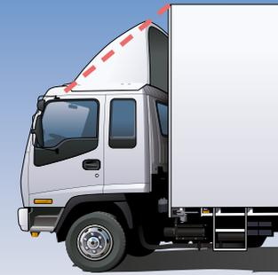
Der Dachspoiler darf nicht über den Aufbau hinausragen. So sparen Sie rund 10% Treibstoff.
