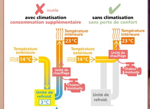
Le principe utilisé pour les voitures est applicable pour les poids lourds: l'air extérieur (p. ex. 14 °C) est refroidi jusqu'à 3 °C, ce qui augmente la consommation de carburant d'une voiture de jusqu'à 5%. Ce n'est qu'ensuite que l'air est porté à la température intérieure souhaitée (idéalement 23 °C).
