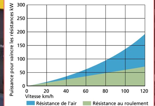
La vitesse croissant, la résistance au roulement et à l'air (résistance à l'avancement) augmente et donc la consommation de carburant. Exemple de lecture: la puissance requise s'élève à environ 95 kW à 80 km/h et à 115 kW à 90 km/h.
