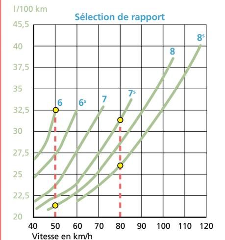
Rouler de manière constante avec des rapports élevés, si possible avec le régulateur de vitesse, permet d'économiser du carburant. Exemple de lecture: rouler en 8<sup>e</sup> plutôt qu'en 6<sup>e</sup> à 50 km/h permet d'économiser env. 11 l/100 km (env. 34%). Et rouler en 8<sup>e</sup> plutôt qu'en 7<sup>e</sup> à 80 permet d'économiser env. 5 l/100 km (16%).
